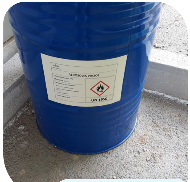
Detalle del etiquetado de los residuos peligrosos.
