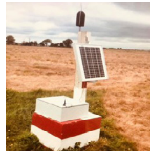
Medidor acústico accionado por energía 100% renovable.
