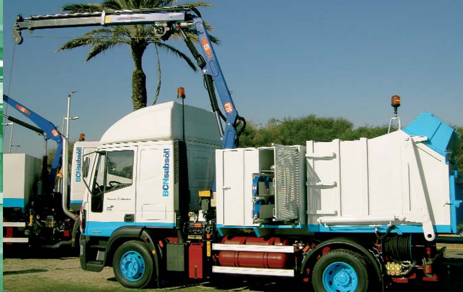
Vehículo de gas natural comprimido para la recolección de residuos sólidos urbanos
