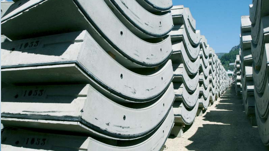
Dovelas de hormigón producidas en la factoría de Humanes. Madrid
